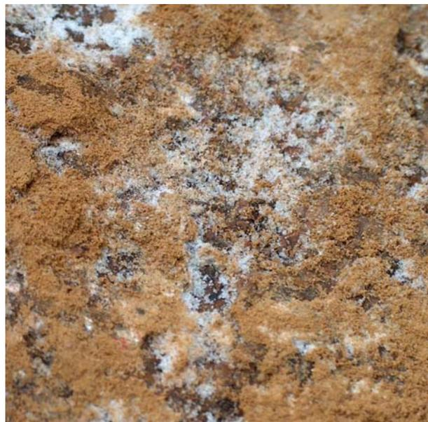
Abbildung 2—8, deutlich sichtbare Salzausblühungen an der Oberfläche des Probekörpers (Granit)
