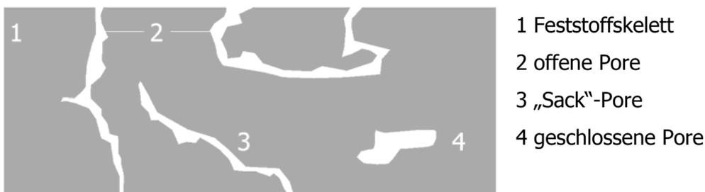
Abbildung 4–20, Schematische Darstellung verschiedener Porentypen eines kapillarporösen Körpers
