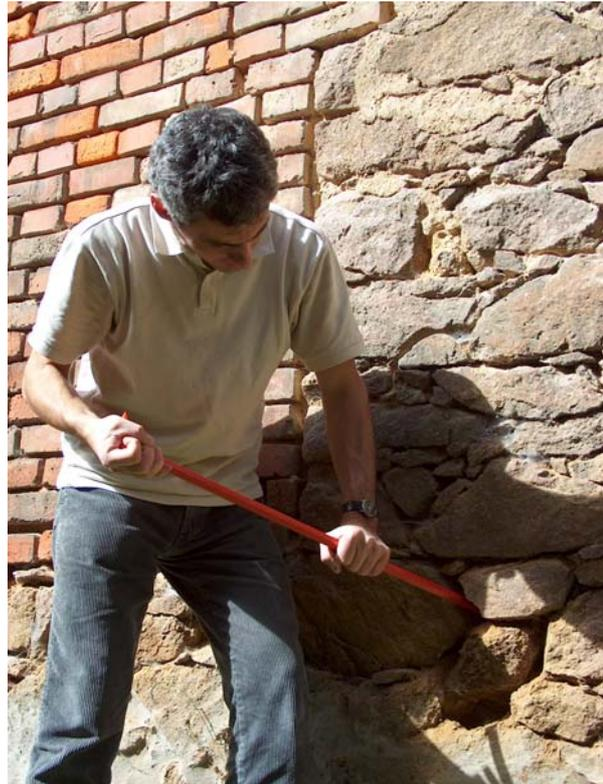
Abbildung 2—7, Entnahme von Materialproben für das Labor des Institutes für Bauklimatik der TU Dresden
